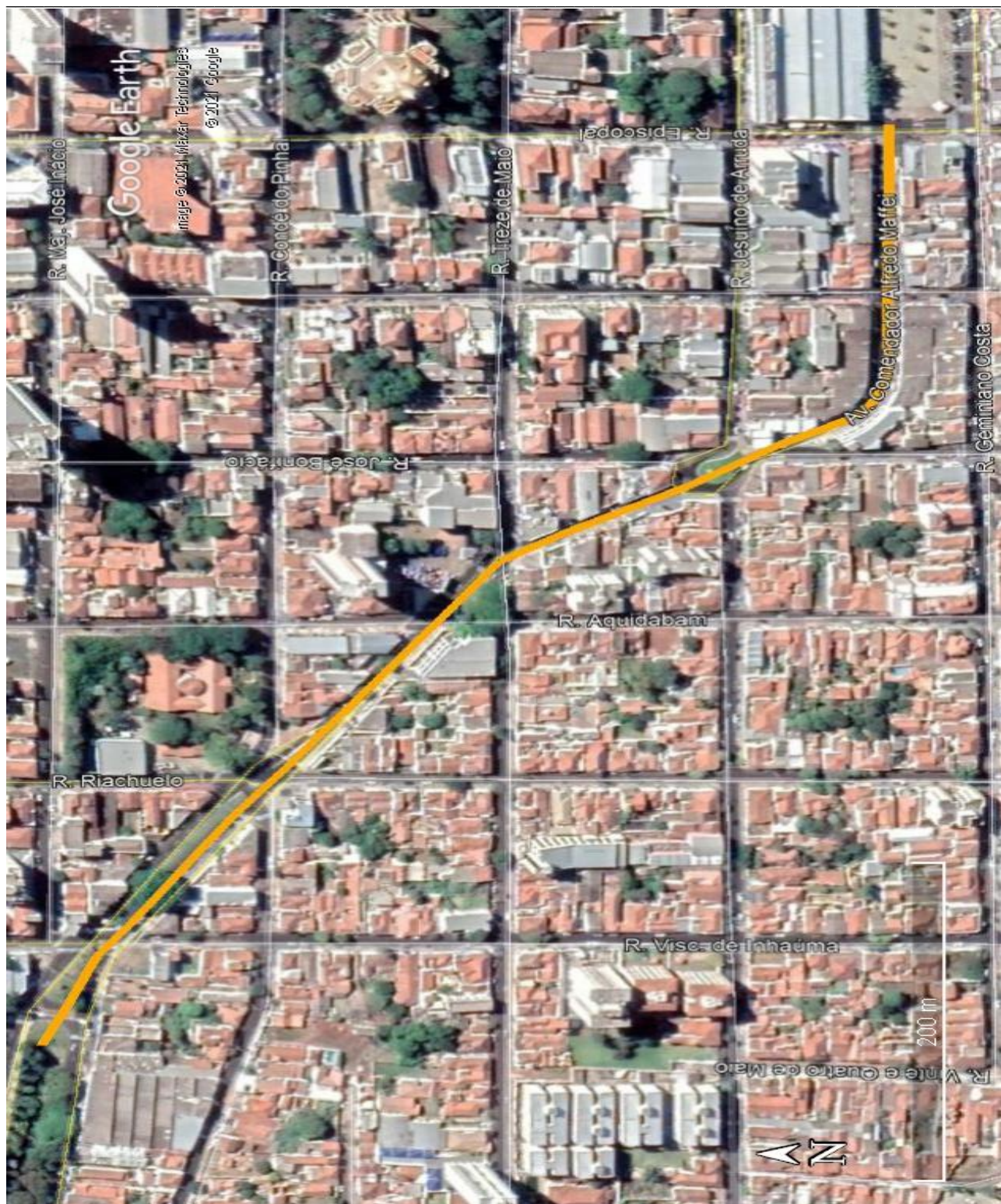
Figura 2 – Trecho subdimensionado do córrego Gregório (Linha Amarela)
