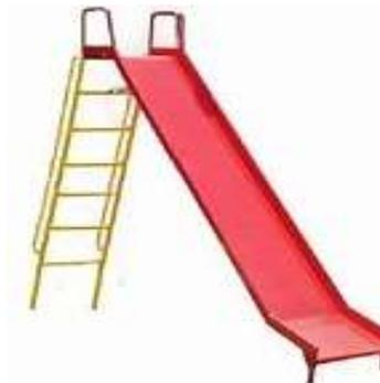
Confeccionado em tubo industrial de 7/8" e 3/4" com parede de 1,50mm e chapa dobrada n° 16, medindo 1,15m largura, 1,80m de altura e 3,20m de comprimento; deslizante medindo 0,40cm de largura, 3,00m de comprimento e leito revestido leito em aço galvanizado, escada em tubo de 2" e 1", com parede de 1,50mm e ferro redondo de 1/2", sendo a pintura em esmalte sintético nas cores: amarelo ouro, vermelho vivo e azul França.
