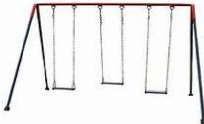
Produzido com tubos de aço, soldagem no sistema mig, de grande durabilidade e resistência do produto. Pintura em esmalte sintético, de alta resistência e correntes galvanizadas. Os assentos podem ser produzidos em madeiras, aço, fibra de vidro plástico com encosto.
