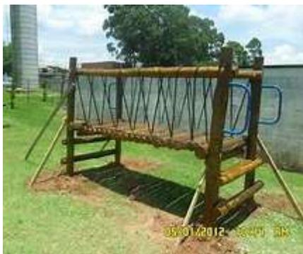
Confeccionado em eucalipto autoclavável, com 02 degraus e suporte para as mãos em tubo industrial de 1" com parede de 2,00mm, com a plataforma presa com cordas e cabo de aço, medindo 1,10m de largura x 1,50m de altura x 3,00m de comprimento, sendo a pintura em esmalte sintético nas cores: amarelo ouro, vermelho vivo e azul França ou na cor natural com verniz brilhante.
