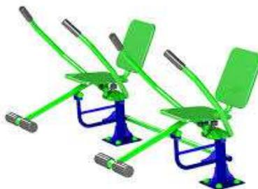
Aparelho para exercício físico: remada sentada. Fabricado com tubos de aço carbono de no mínimo 2" x 2 mm; 1" ½ x 1,50 mm; 1" x 1,50 mm; rolamentos blindados, solda mig cortes a laser, pintura a pó eletrostática, batentes de borracha, fixação do equipamento com chumbadores parabout; tampão de metal arredondado; bancos arredondados sem quina; carga máxima de 10 kg (total); o aparelho deve permitir a prática de 1 (um) usuário. Cores: azul e amarelo.
