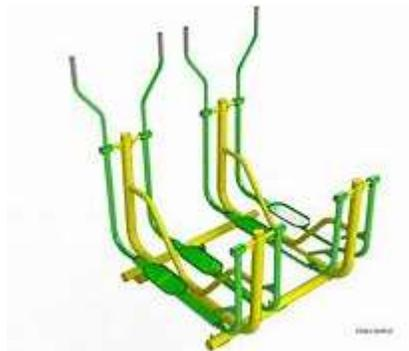
Fabricado com tubo de aço carbono de 1', 1 ½', 2 ½' e tubo retangular de 50x30mm, manoplas emborrachadas, pedaleira em alumínio e pintura eletrostática de alta resistência, tampões de aço para proteção dos rolamentos, parafusos e porcas antioxidantes. Dimensões: altura 1,6m; largura 1,5m; comprimento 1,2m; peso 60kg.
