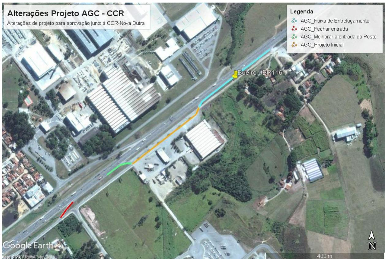
O projeto, por exigência da CCR Nova Dutra, determinava o fechamento de um dos acessos existentes (em vermelho), adequação geométrica de outro acesso existente (em verde) e novo acesso à Via Dutra (em amarelo) com adequação do acostamento existente (em azul).
