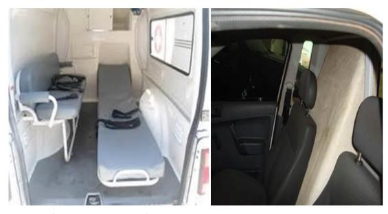
As fotos acima, são um veículo com deslocamento do banco do passageiro para a instalação da maca.
